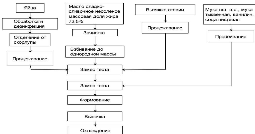
Рисунок 1 – Технологическая схема производства песочно-отсадного печенья
